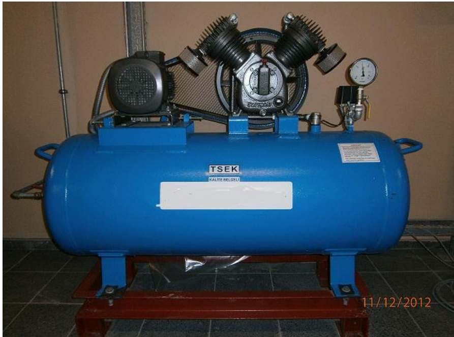
Şekil 5. 30: Su borularına hava dolduran pistonlu kompresör
