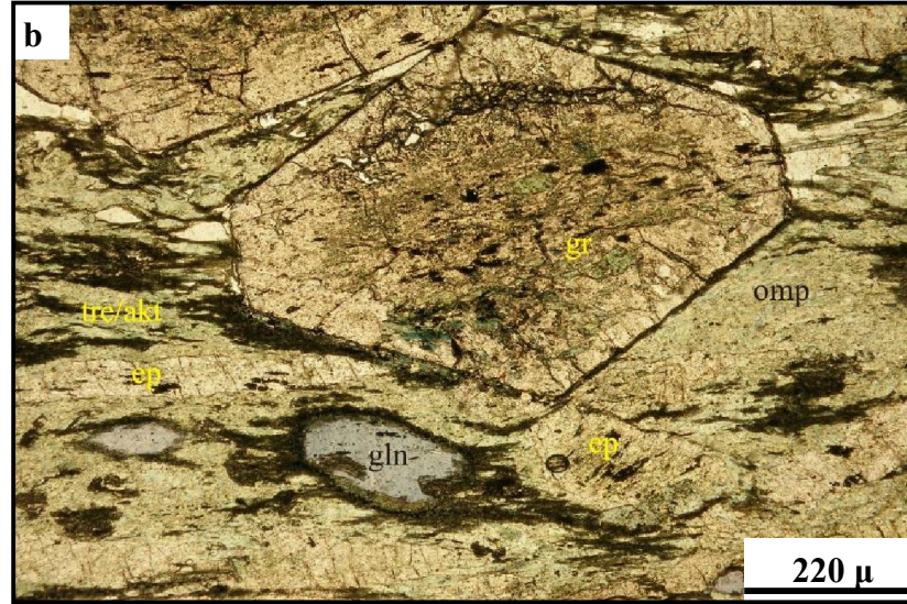
Şekil 4.2.28. a, b) Eklojitlerin genel mineral bileşimlerini içeren mikroskop altındaki görünümü (gr: granat, ep: epidot, omp: omfasit, gln: glokofan, tre/akt: tremolit/aktinolit; a, b: çift nikol).
