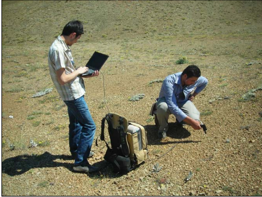
Şekil 5.5: Arazi ölçümlerinde kullanılan spektrometre düzeneği
