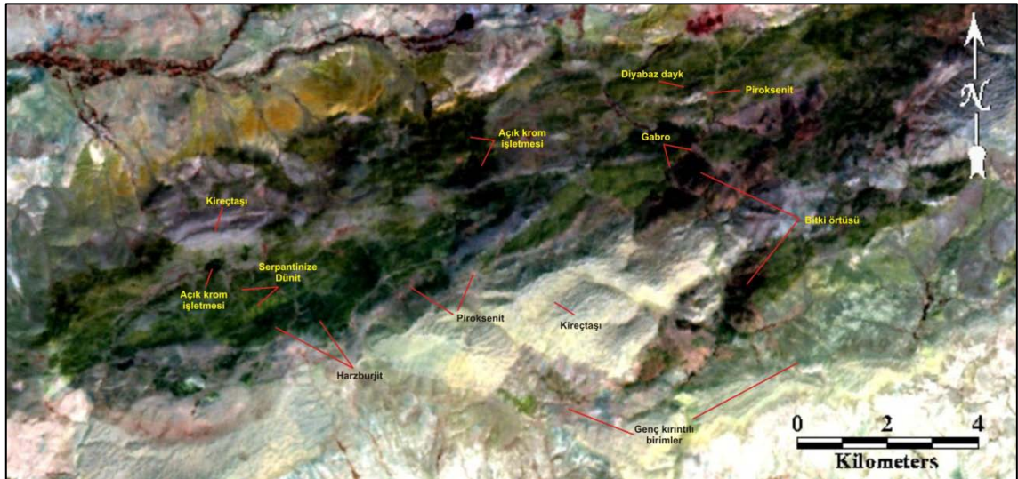
Şekil 6.12: Log residual uygulaması, ASTER SWIR bantlarından 4,5 ve 8' in kırmızı, yeşil ve maviye atanması sonucu elde edilmiştir. Görüntüde serpantinize dünit, harzburjit, piroksenit, kireçtaşı, gabro, diyabaz dayk ve kromit yatakları ayırt edilmiştir.
