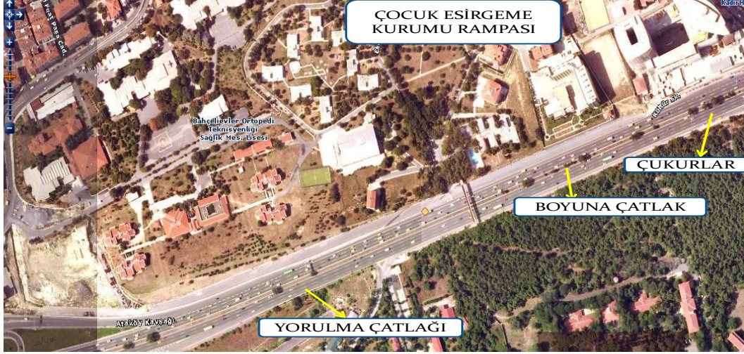
Şekil 5.14 : D-100 karayolu Devlet Hastanesi (2,5 – 3,5 km arası) bozulmalara ait plan
