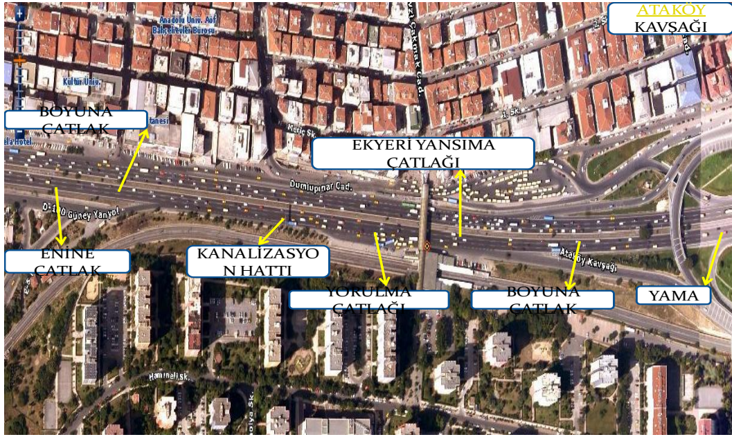
Şekil 5.11: D-100 karayolu Ataköy kavşağı (1,5 – 2,5 km arası) bozulmalara ait plan
