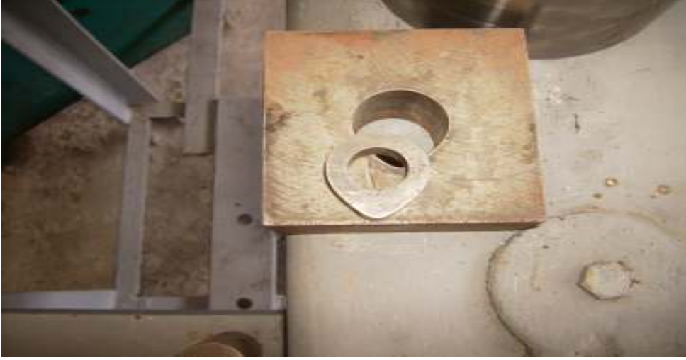
Şekil 5.6 Hatalı kalıp görünümü
