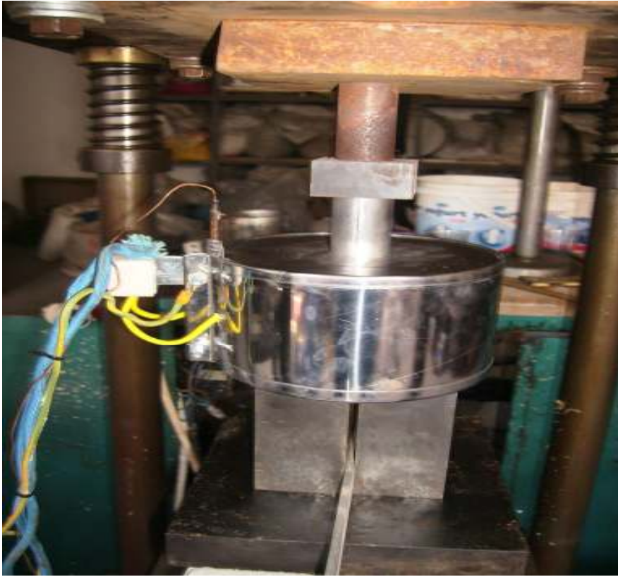
Şekil.5.3 Kam üretiminde kullanılan prese bağlanmış kam kalıbı ve ısıtıcı
