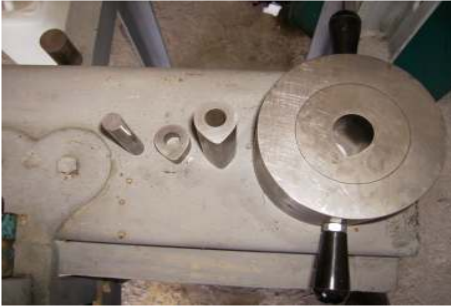
Şekil 5.2 Üretilecek kam için imalatı yapılmış kam kalıbı ve parçaları
