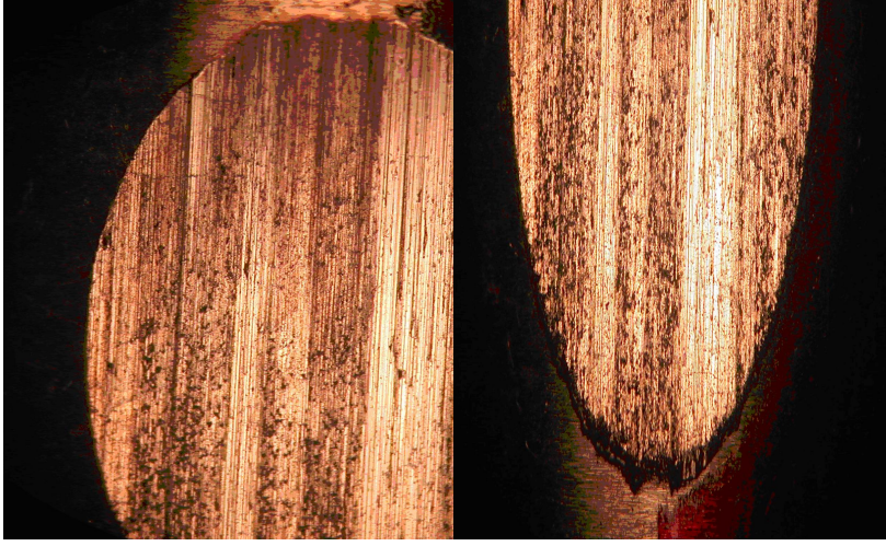
Şekil 4.12 Örtülü Elektrot ile ark kaynağı yapılmış numunenin aşınma yüzeyine ait metal mikroskobu görüntüsü
