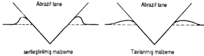
Şekil 3.6 Sertleştirilmiş ve Tavlanmış malzeme üzerinde bir abrazif tanenin izinin şematik gösterilişi [16]
