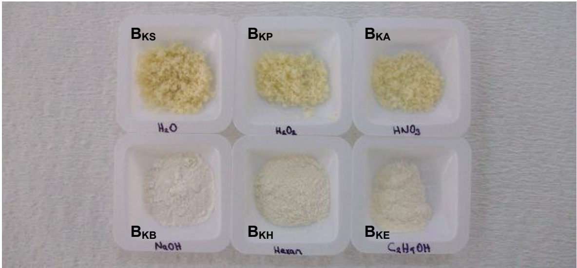
Şekil 25. Farklı çözücülerle (H 2 O, H 2 O 2 , NHO 3 , NaOH, Hekzan, Etanol) temizlenmiş balık kemikleri
