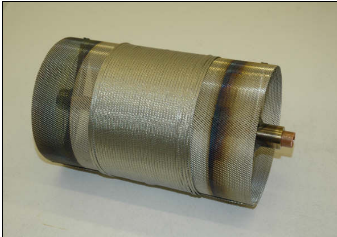
Şekil 1. Nano gümüş parçacıkları ile kaplanmış tel.
