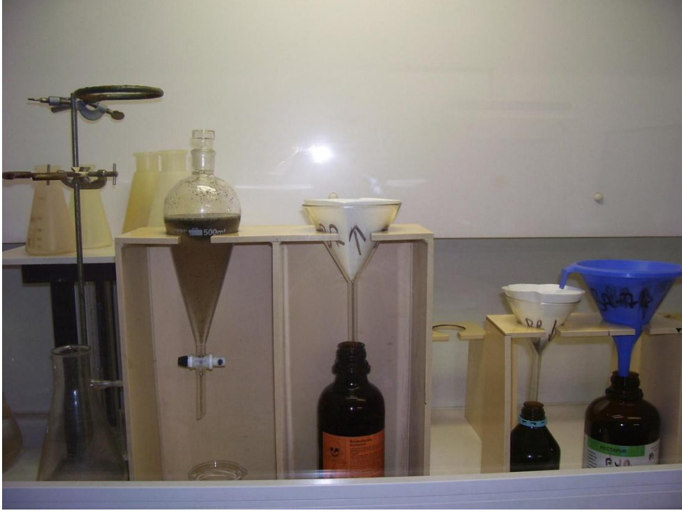
Şekil 2.2. Yaş analizi için kayaç örneklerinden elde edilen minerallerin ağır sıvı metoduyla zenginleştirilmesi.
