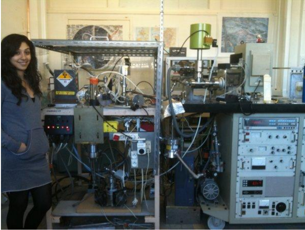
Şekil 2.1. Yaş analizlerinin yapıldığı Ar Spektrometresi cihazının görünümü.
