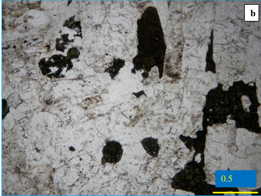
Şekil 4.18. Karaveli Kuvars Monzoniti içinde tanımlanan monzonit örneğinin mineral parajenezi ve genel görünümü (BA-45, a ) çift nikol, b ) tek nikol). (Mineral kısaltmaları için bakınız sayfa XVII).
