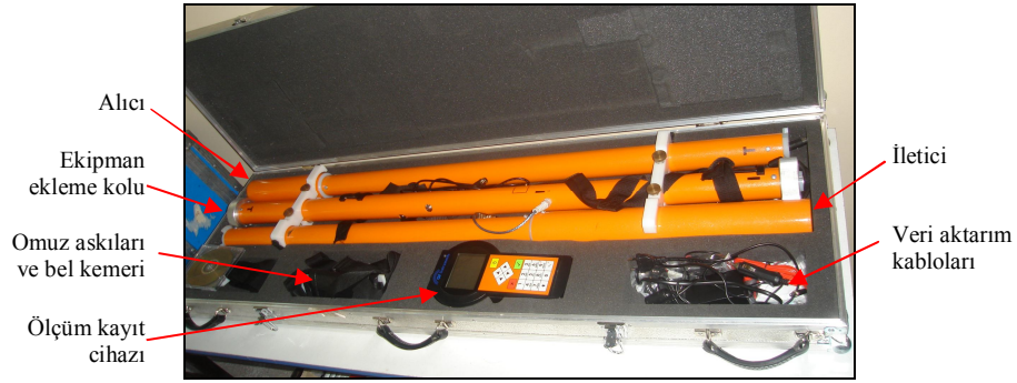
Şekil 2.5. CMD4 cihazını oluşturan elemanlar.
