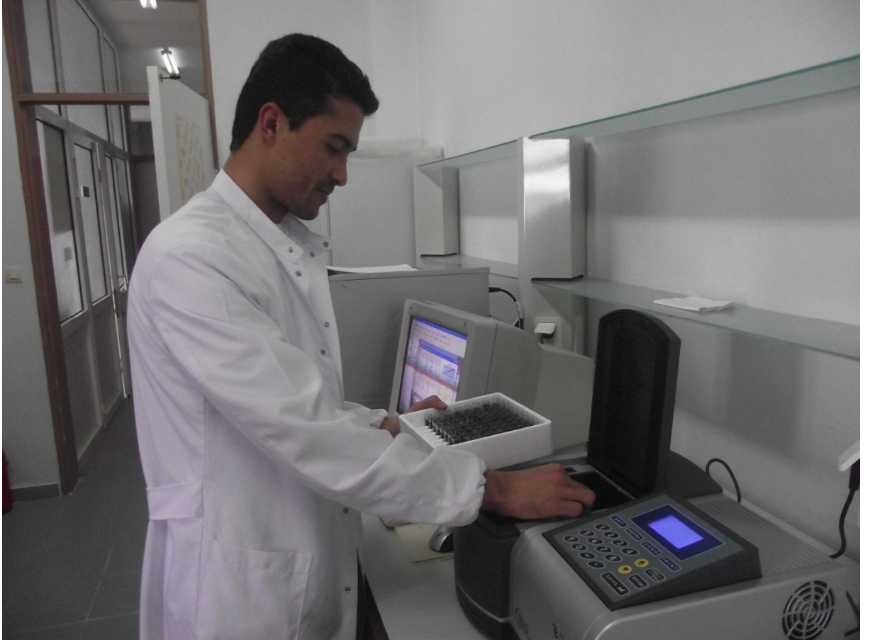
Şekil 6. Karbonhidrat analizinin gerçekleştirildiği spektrofotometre cihazı (PG T60 UV-VIS).
