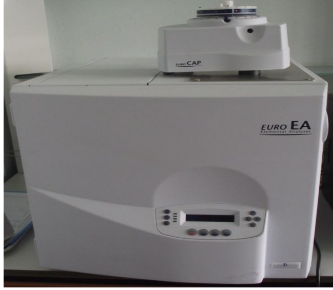
Şekil 5. Protein analizinde kullanılan elemental analiz cihazı (EA 3000 Eurovector).
