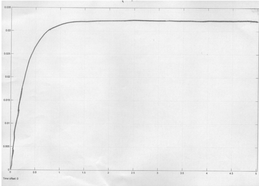
Şekil 9.13 Manipülatörün PID kontrol altında basamak formunda giriş sinyaline karşılık x eksenindeki çıkış sinyali
