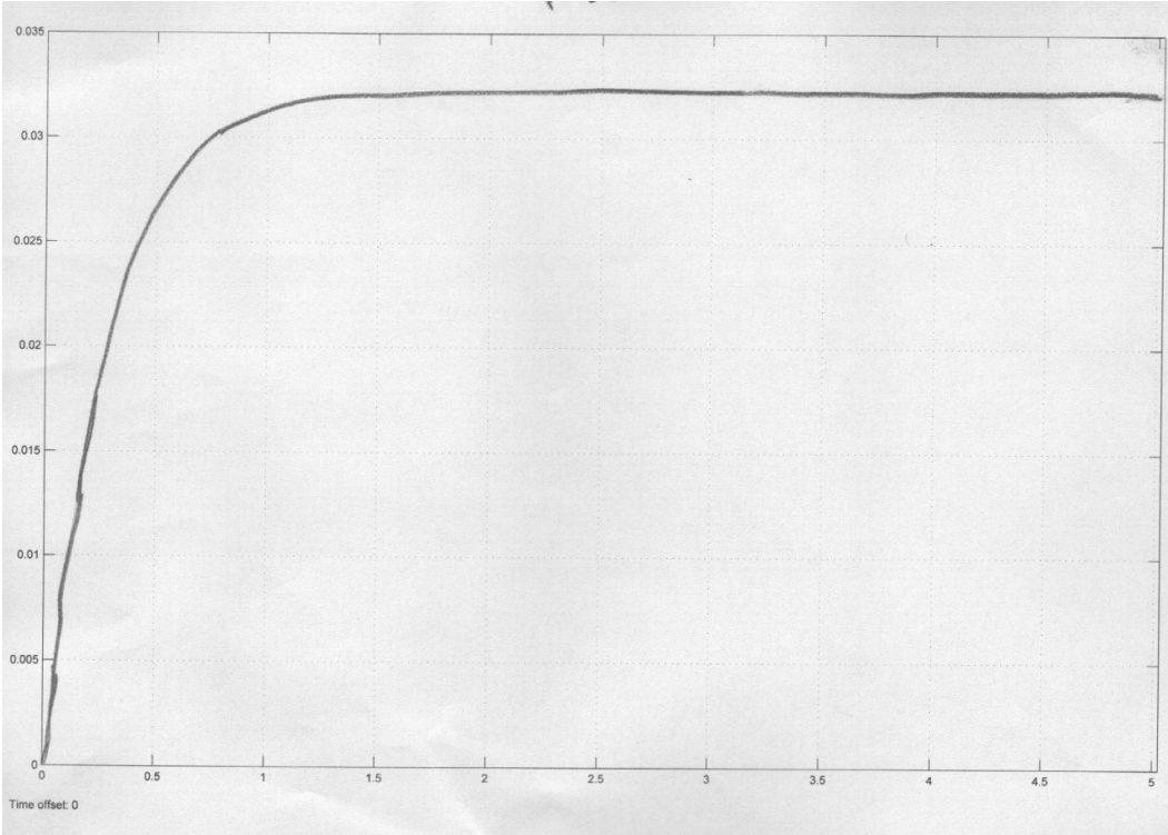
Şekil 9.17 Kartezyen manipulatörün PID kontrol altında basamak formunda giriş sinyaline karşılık z eksenindeki çıkış sinyali
