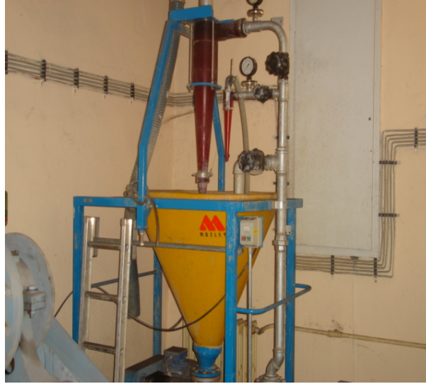
Şekil 3.3 Mozley C124 hidrosiklon deney düzeneği
