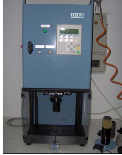
Şekil 3.13 Döküm testleri için kullanılan DİSA marka Mini Lab cihazı
