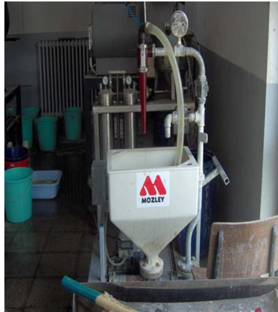
Şekil 3.4 Mozley C705 hidrosiklon deney düzeneği
