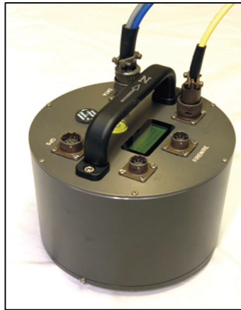
Şekil 4.12 Guralp marka CMG -5TD tipi ivme kayıtçısı
