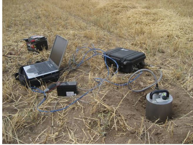
Şekil 4.1 Mikrotremor ölçümlerinin alınması için kullanılan ekipmanlar
