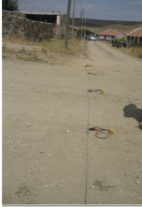
Şekil 4.8 Çalışma alanında Re-Mi ölçümü dizilimi
