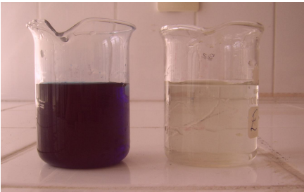
Şekil 4.10 Dolgulu kolona Metilen Blue boyar maddesinin giriş ve çıkış suyu görüntüsü
