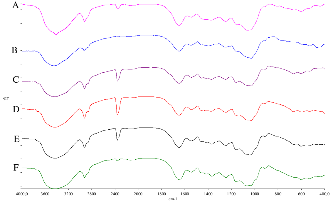
Şekil 4. 41. C. racemosa 'nın FTIR spektrumu, (A), Pb, (B) Co, (C) Cu, (D) Zn, (E) Cd yüklenmiş ve (F) ham hali
