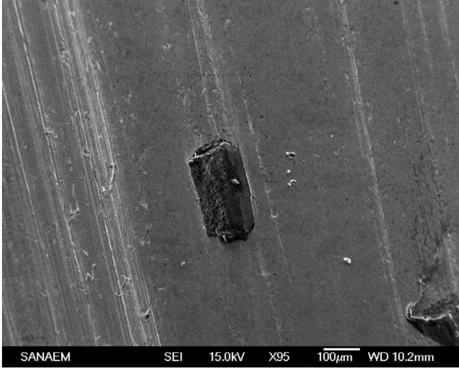
Şekil 6.44: 1.grup soket için ( C_5 1000°C), matrikse gömülmüş elmas tanesinin SEM görüntüsü, elmas-matrix ile güçlü bir bağ yapmış.
