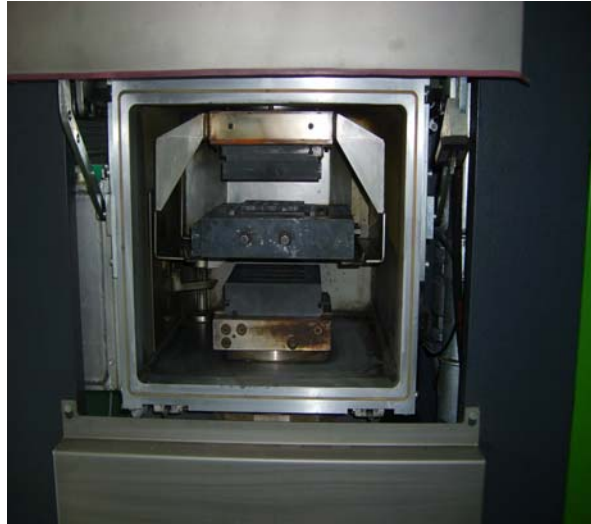
Şekil 5.4: Kalıp içerisinde sinterlenmiş elmas katkılı soketlerin sıcak pres içerisindeki görünümü.
