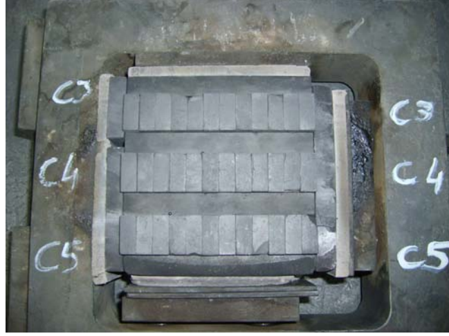
Şekil 5.8 : Üretilen elmas soketlerin sinterlendikten sonra grafit kalıp içerisinde görünümü.
