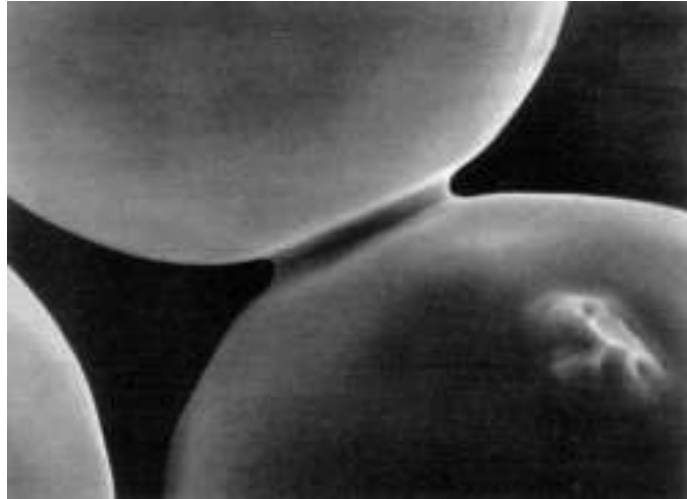
Şekil 3.15: Tozların sinterlemesi sırasında boyun oluşumunun ilk safhalarına ait şematik bir resim [46].
