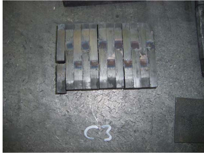
Şekil 5.9 : Üretilen elmas soketlerin sinterlendikten sonra nihai görünümü.
