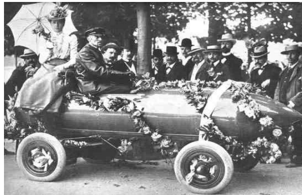
Şekil 2.2 Camille Jenatzy, tarafından 1899 yılında yapılan rekor kıran araba, maksimum hız: 105,9 km/h (Hucho [27])
