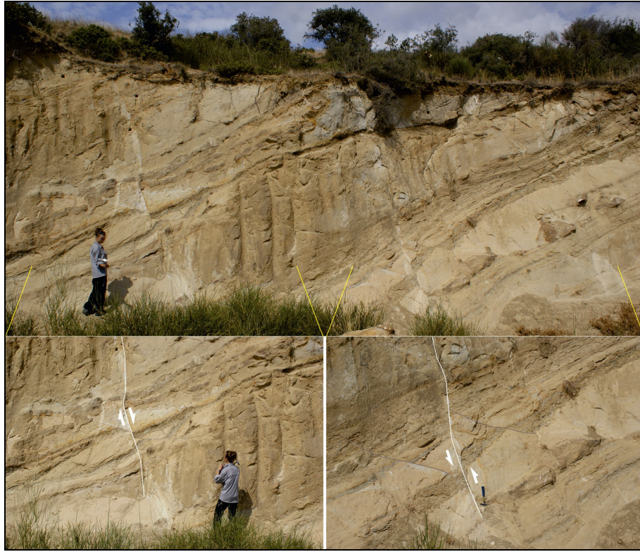
Şekil 4.53. Şarköy Göleti batısında gözlemlenen normal ve ters faylar (UTM Koordinatlar 35 T 0508098 D / 4498507 K; Bakış Yönü: Doğu'dan, Batı'ya).
