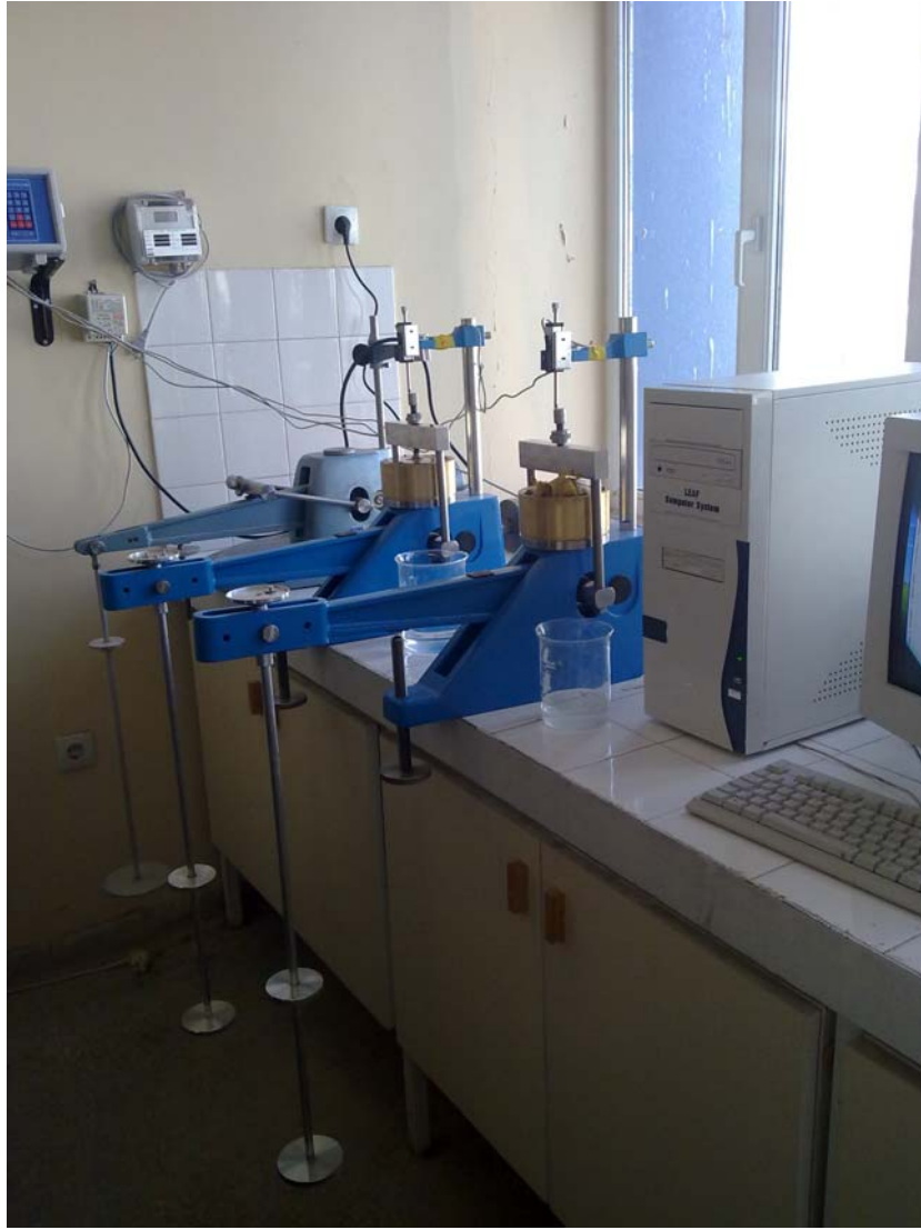
Şekil 5.1. Serbest şişme deneylerinin gerçekleştirildiği deney düzeneği.
