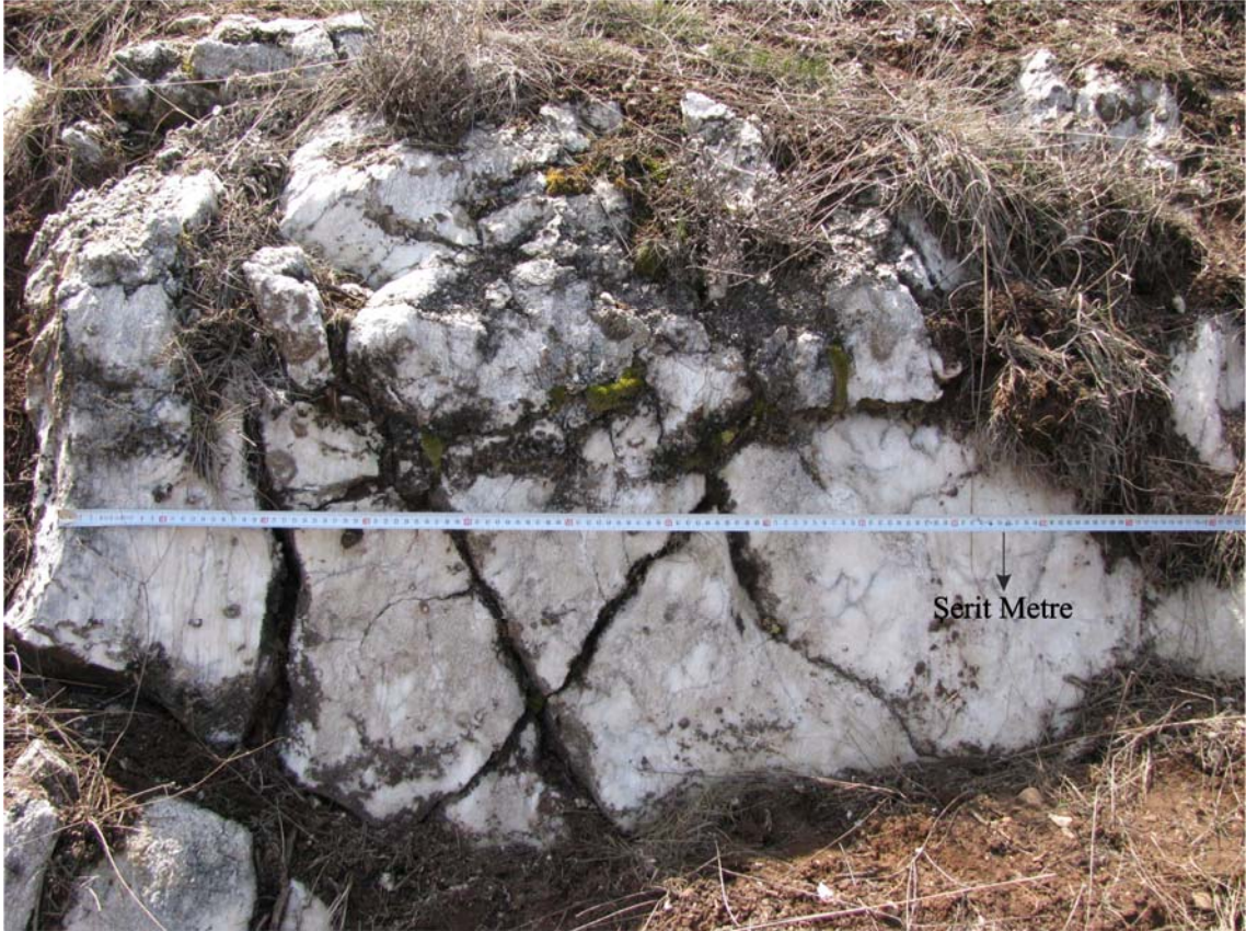
Şekil 5.4. Jips kaya kütlelerindeki süreksizlik aralıklarının hat etüdü yöntemiyle ölçülmesi (Seyfebeli civarı)
