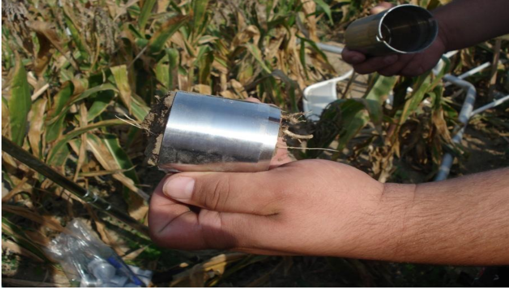
Şekil 18. Bozulmamış örnek silindiri ile kök örneklerinin alınması.
