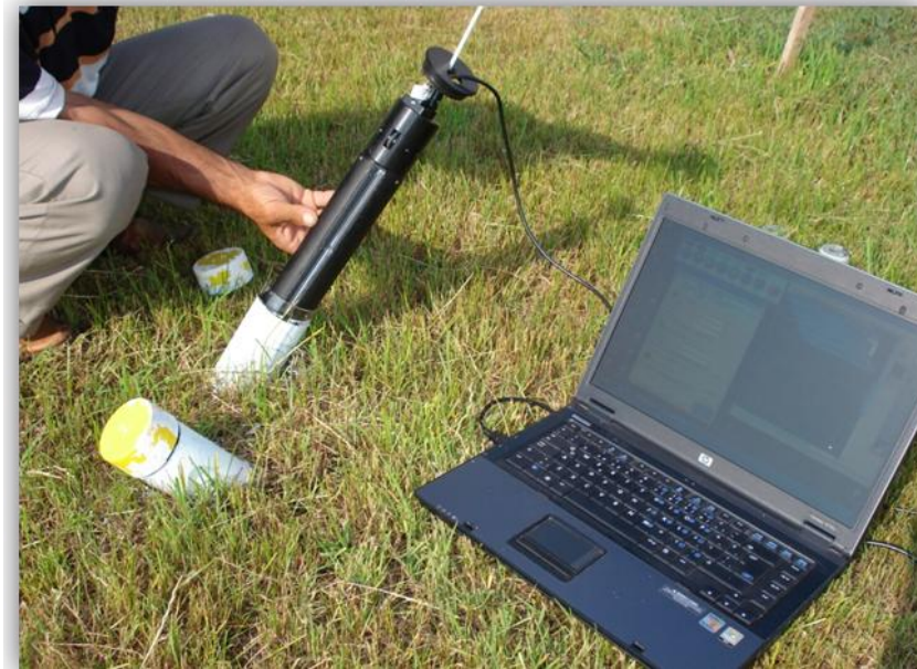
Şekil 3. Minirhizotron yöntemiyle kök görüntüsü elde edilmesi.
