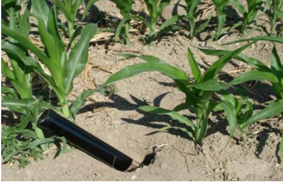
Şekil 10. Kök gözlemlerinde kullanılan minirhizotron tüpü.
