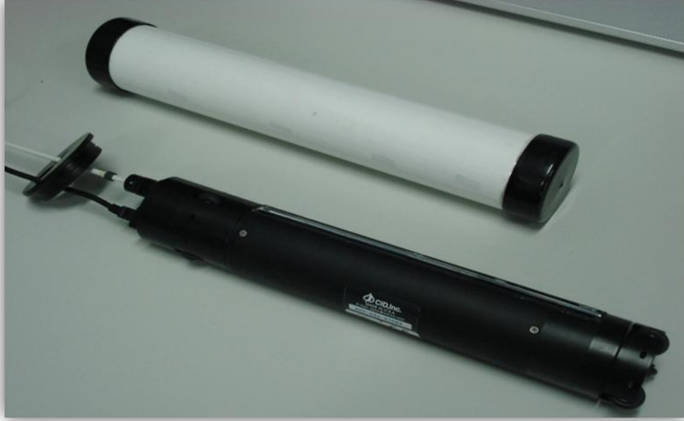
Şekil 8. Minirhizotron kamera ve pleksiglass kalibrasyon tüpü.
