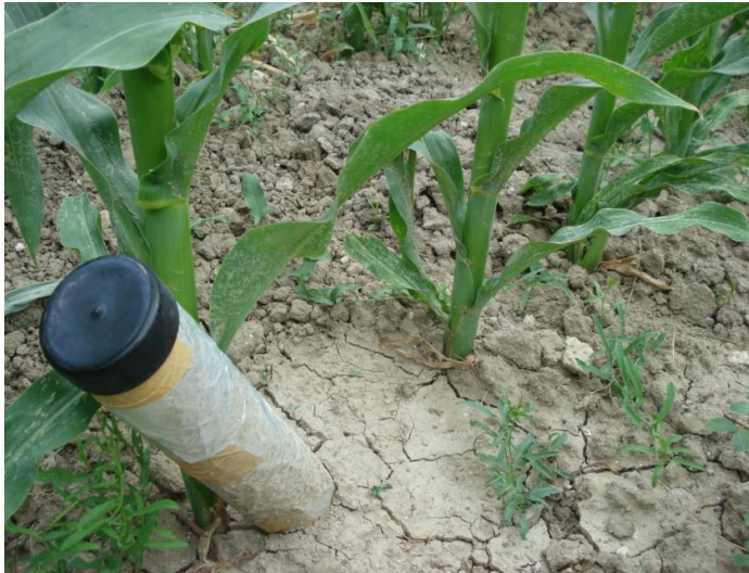
Şekil 14. Minirhizotron tüpün arazide konumlanması.
