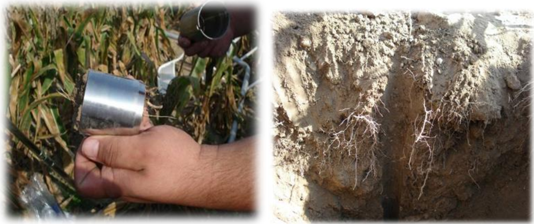
Şekil 1. Toprak core yöntemi ile kök örneklerinin alınması.
