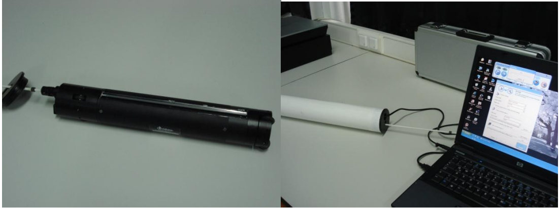
Şekil 2. Minirhizotron kamera ve bilgisayar bağlantısı ile görüntü alımı.
