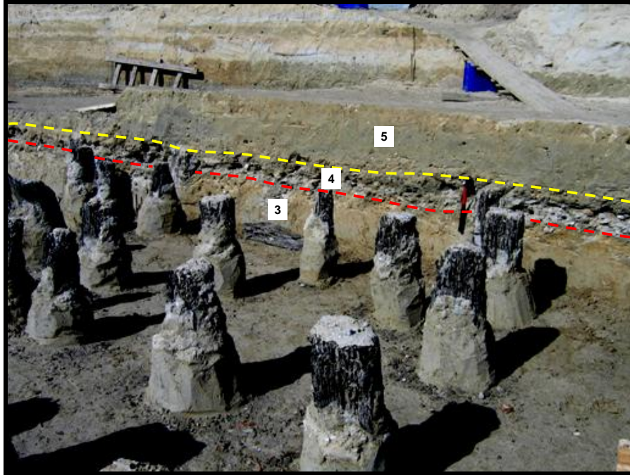
Şekil 3.1.2. Tsunami öncesi inşa edilen kazıklardan alınan numune yerleri.
