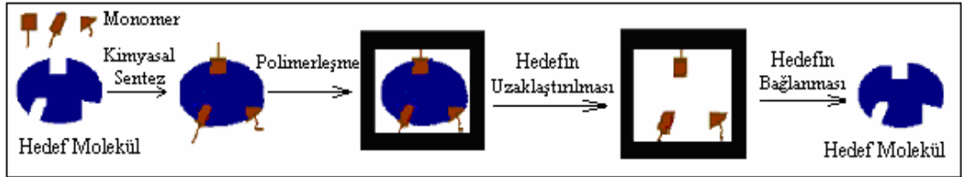
Şekil 4.5. Kovalent baskılamanın şematik gösterimi [Denizli A., Ersöz A., Say R., 2004].
