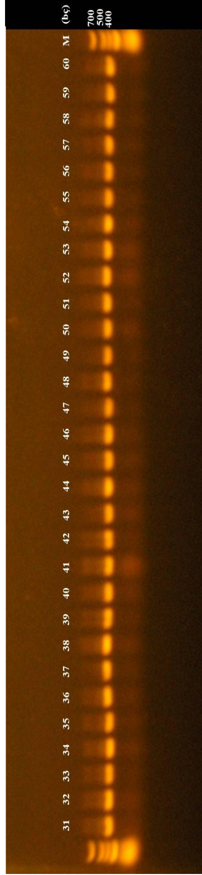
Şekil 4.11. M. pulcherrima maya suşlarının PCR ile amplifikasyonu (MP-1 – MP-30).
