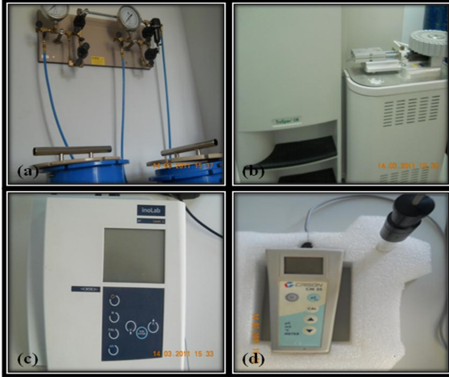
Şekil 4. Toprak ve su analiz cihazları; (a): pF cihazı, (b): C-N analizatörü, (c): pH metre, (d): EC metre.
