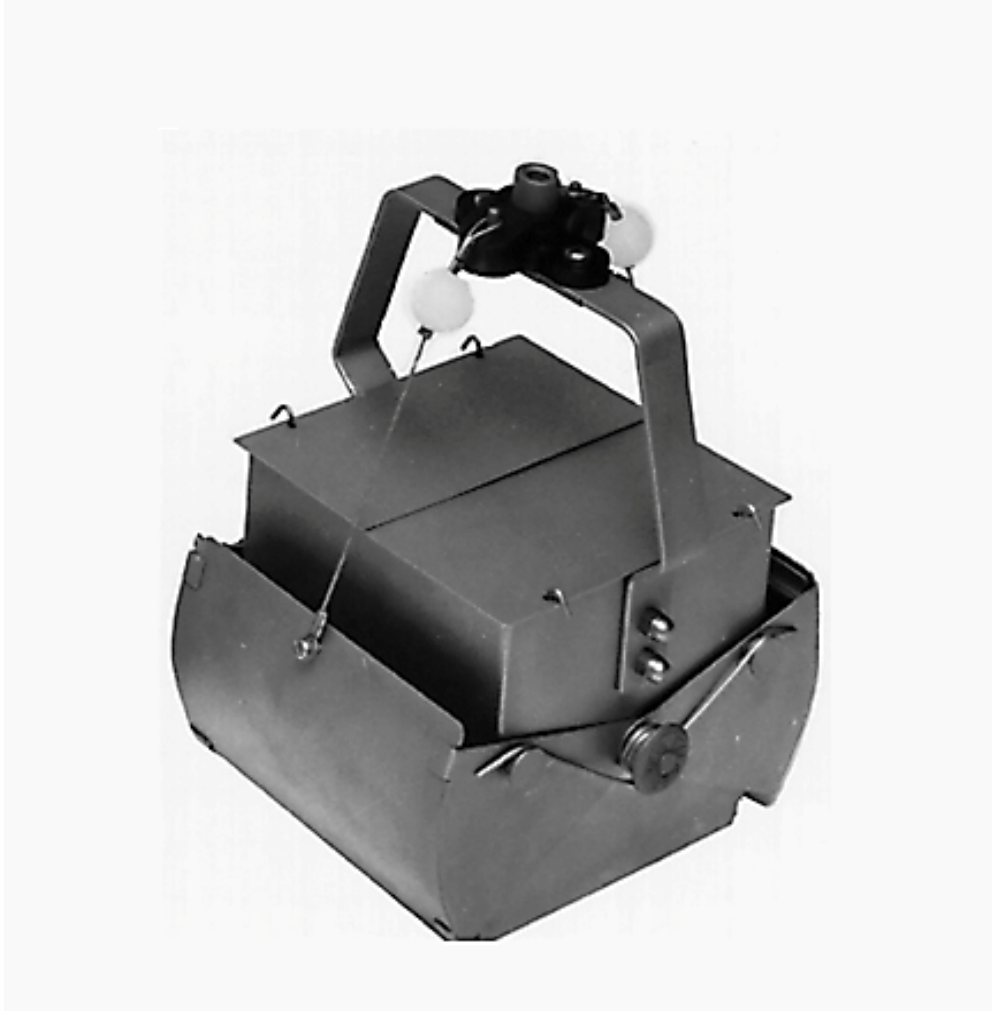
Şekil 3.3. Grab sedimet örneği aldığımız alet.
