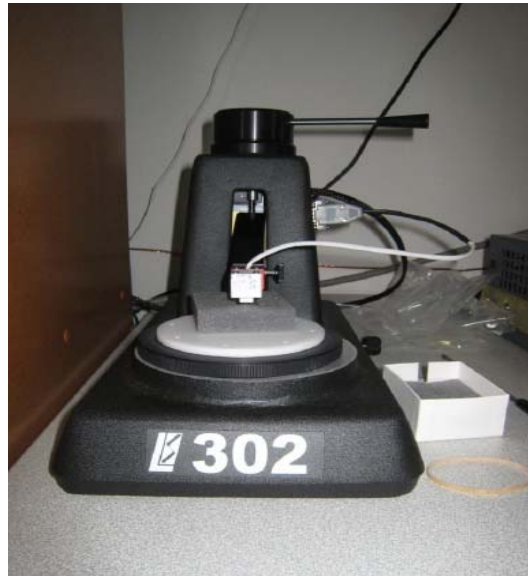
Şekil 3.11. “Jandel Universal Probe System” dört nokta iletkenlik ölçüm sistemi.
