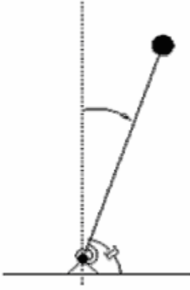
Şekil 2.4 Bir yay ve amortisör gibi modellenmiş pasif mekanizmalı ters sarkaç
