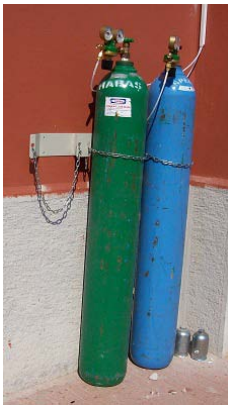
Resim 3.1. Argon ve azot gaz tüpleri.
