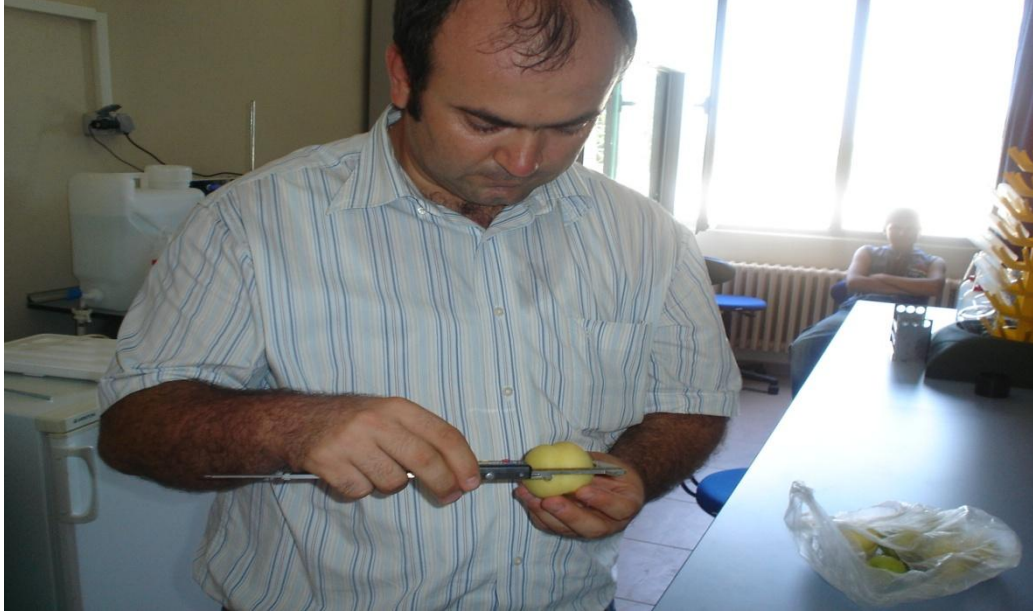
Şekil 23. Dijital kumpas ile meyve eninin ölçümü.
