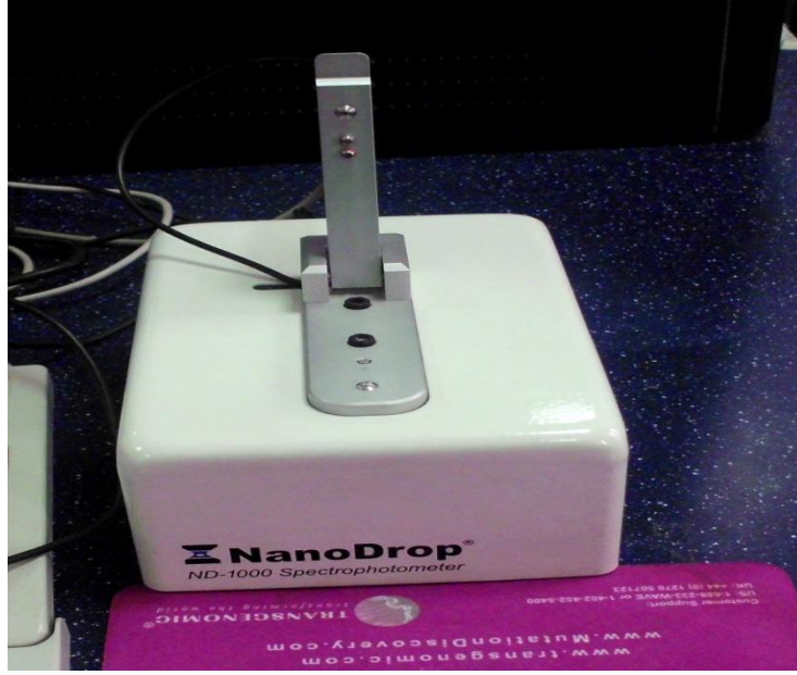
Şekil 16. DNA kalite ve kantitesinin belirlenmesinde kullanılan spektrofotometre (nanodrop)
