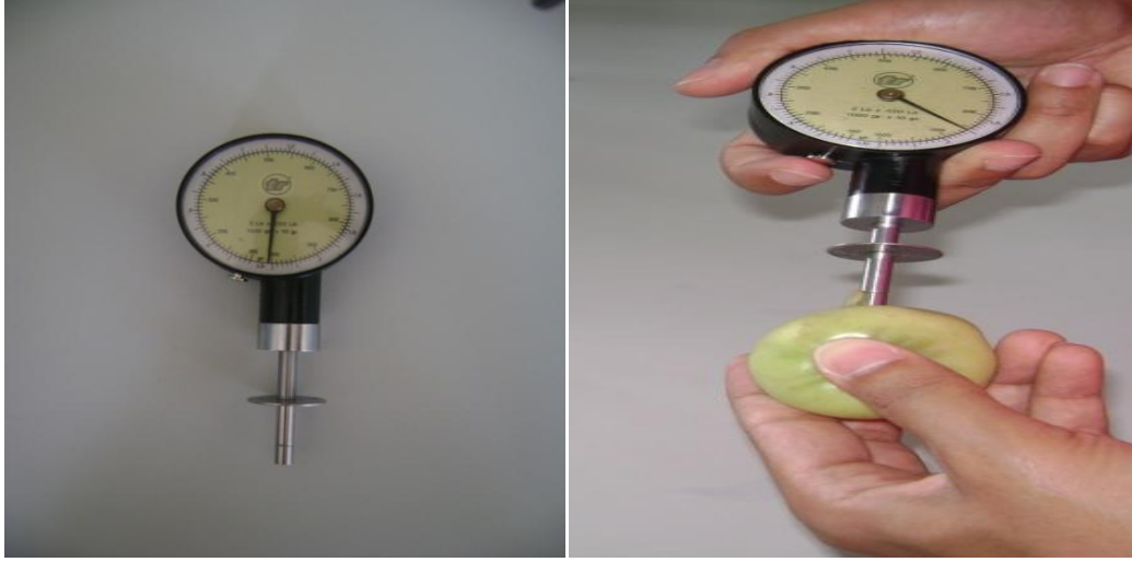
Şekil 24. Penetrometre yardımı ile meyve eti sertliği ölçümü.
