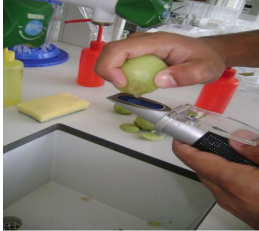
Şekil 25. El refraktometresi yardımı ile suda çözünebilir toplam kuru madde miktarı ölçümü.
