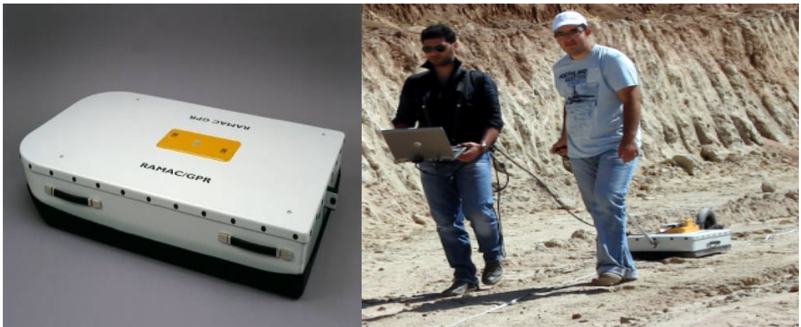
Şekil 3.18 Ramac GPR cihazı ve çalışma alanından bir görüntü
