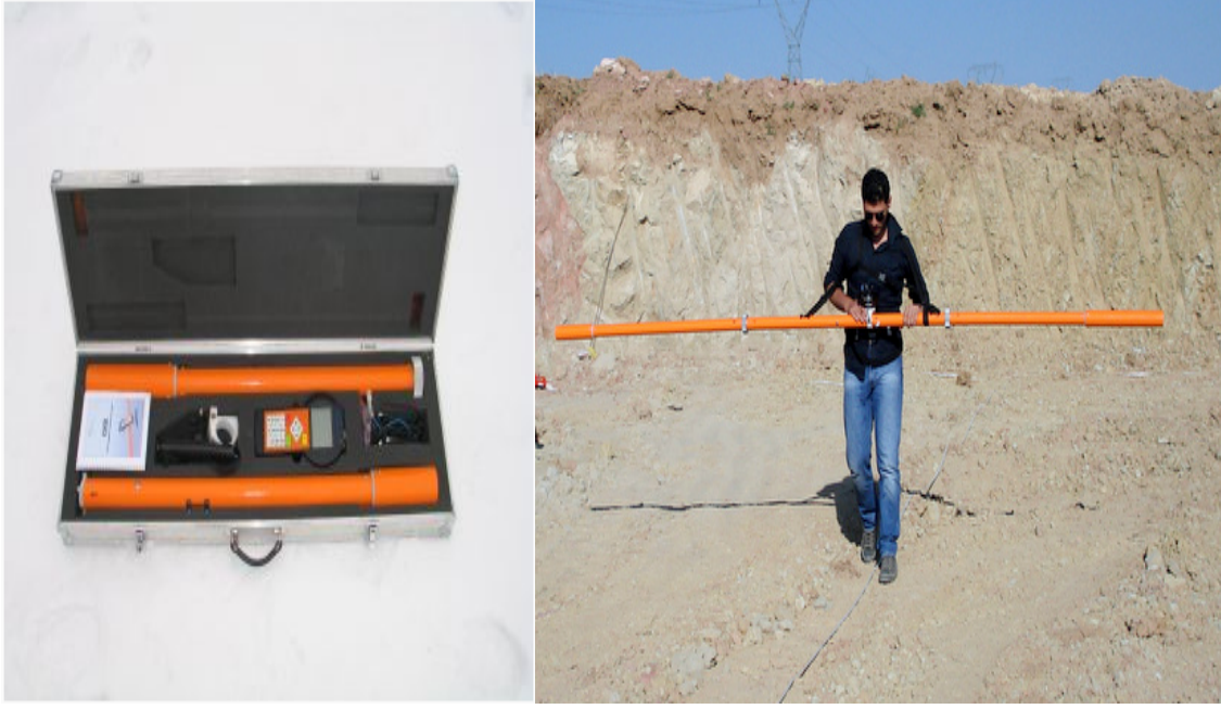
Şekil 3.19 Gf Instrument EM iletkenlik cihazı ve çalışma alanından bir görüntü
