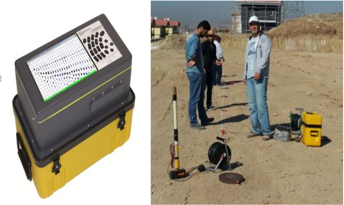
Şekil 3.20 Geometrics Smart Seis 12 MASW cihazı ve çalışma alanından bir görüntü
