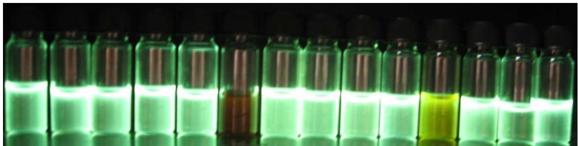
Şekil 28. Bistiyofer ester 43 ve çeşitli metal iyonlarından (1 eşd) oluşan \text{CH}_3\text{CN} çözeltilerinin ( 2,5 \cdot 10^{-4} \text{M} ) a) gün ışığında ve b) UV lamba altında ( 365 \text{nm} ) görünümü.
