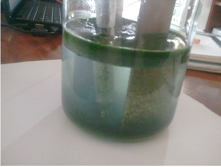
Şekil 4.20. 5 cm genişliğe sahip elektrot ile yapılan kümeleştirme işlemi
