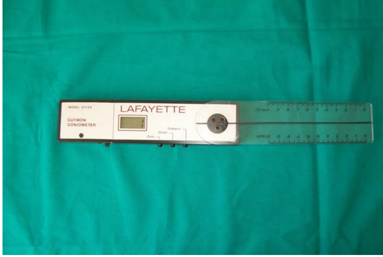
Şekil 2: LAFAYETTE marka 1° duyarlı dijital gonyometre.
