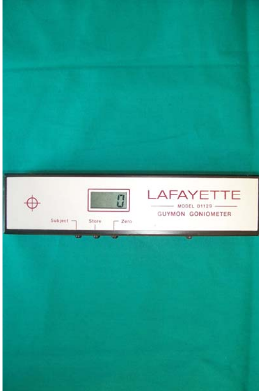
Şekil 1: LAFAYETTE marka 1° duyarlı dijital gonyometre.
