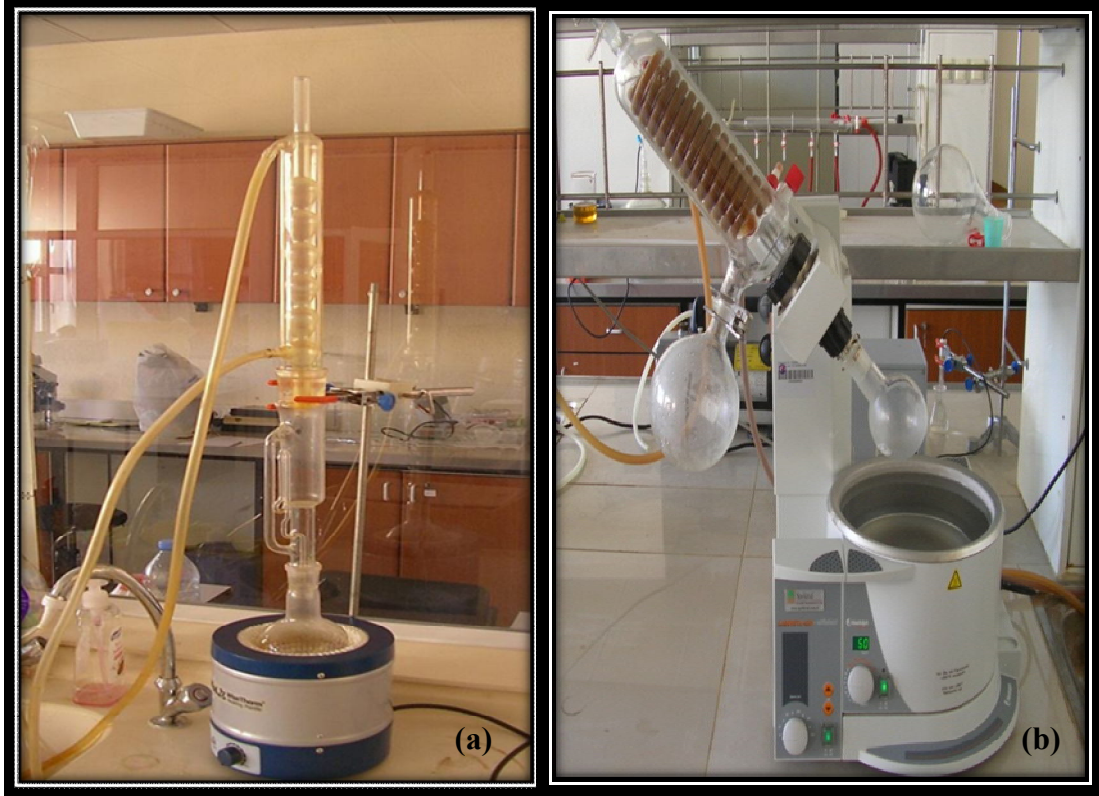
Şekil 5. Ekstraktların elde edilmesinde kullanılan cihazlar. (a) Soksilet ve (b) Evaporatör.
