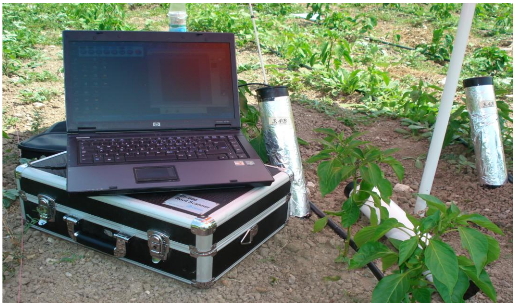
Şekil 5. Minirhizotron kamerada ölçüm alınması
