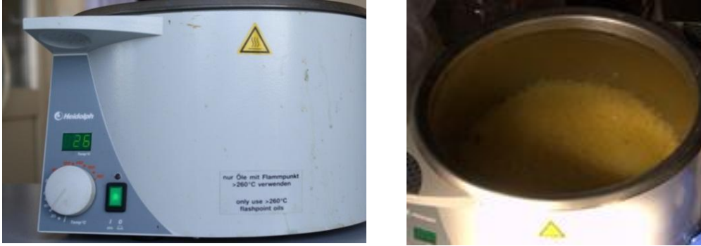
Şekil 17. 26 °C’ye ayarlanmış termostatlı su kazanında yumurtalara ısı şoku uygulaması (Orjinal).
