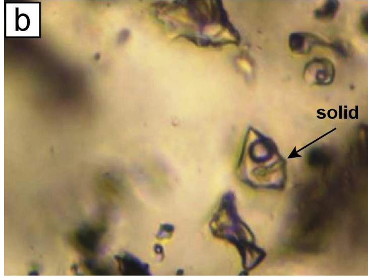
Şekil 5.1 (b) : Kuvars kristalleri içinde, katı faz içeren kapanımlar. (Örnek no: ATM-47, Azıtepe Sahası)
