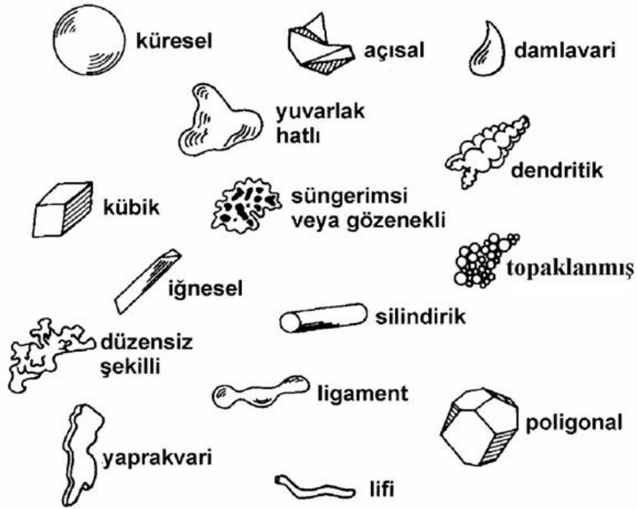
Şekil 2.4 Çeşitli üretim teknikleri ile üretilmiş toz şekilleri (Sarıtaş vd., 2007).
