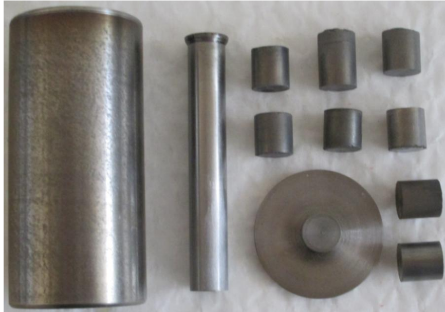
Şekil 4.9 Üretilen MMK aşınma numuneleri ve kalıp parçalarının fotoğrafı.
