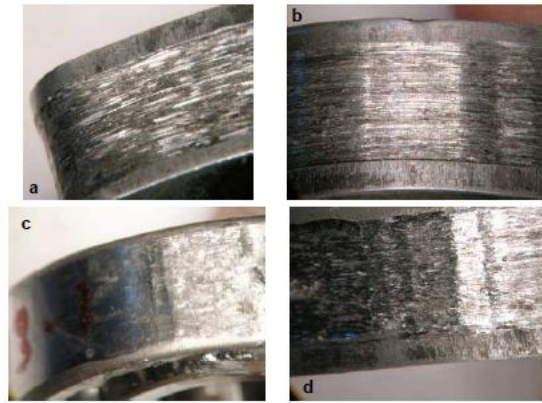
Şekil 1.21 AA2124/B 4 C/30 kuru şartlardaki aşınma sonrası kompozit kamin makro yüzey görüntüsü (Cerit, (2010)).
