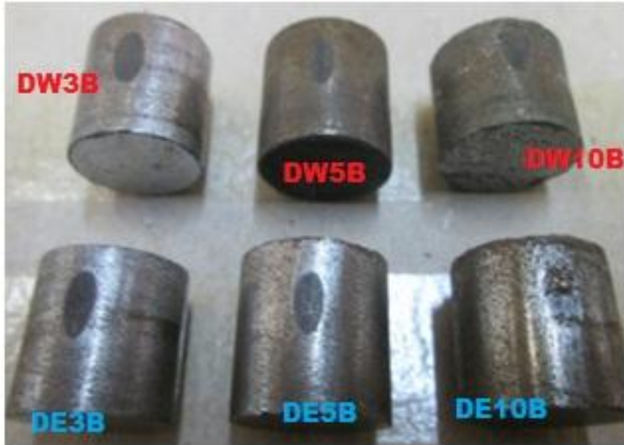
Şekil 5.11 Aşınma testleri sırasında oluşan yüzey deformasyonları.
