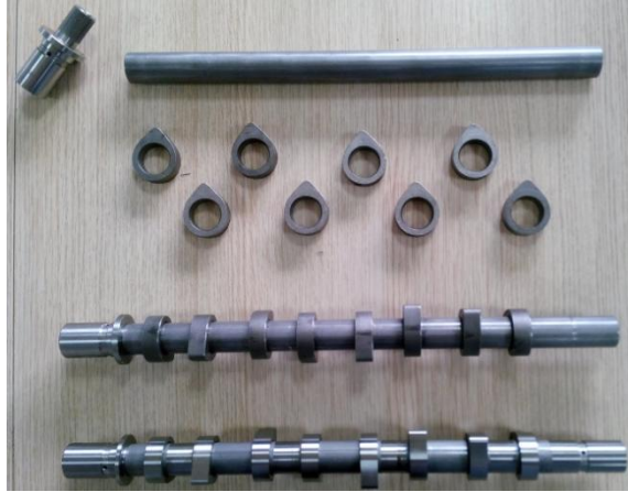
Şekil 1.2 Çelik ve dökümlü montajlı kam mili (Estaş).
