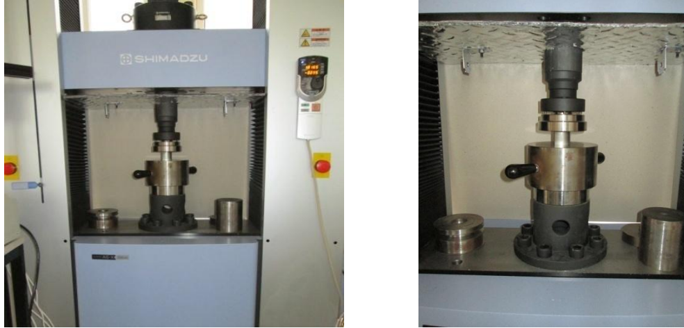
Şekil 4.25 MMK kam numunelerinin kalıplanmasında kullanılan sistem.
