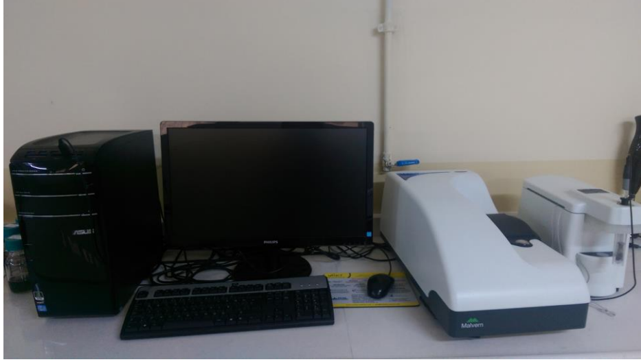
Şekil 2.2 Nanoakışkanların kararlılık testlerinin incelenmesinde kullanılan Malvern Zetasizer Nano Z.
