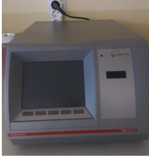
Şekil 2.3 Newton kuralına uyan DI su ve nanoakışkanların yoğunluk ölçümlerinin yapıldığı DMA 4100 dijital yoğunluk ölçme cihazı.
