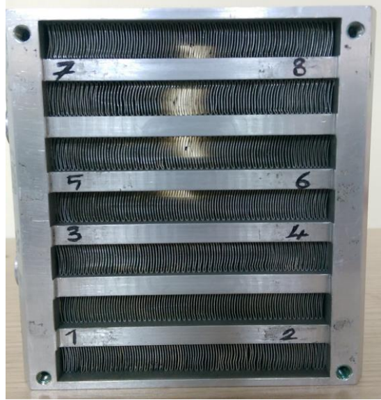
řekil 3.1. ASELSAN A.ř. tarafından tasarlanan ve üretilen mikrokanallı ısı deęiřtiricisi
