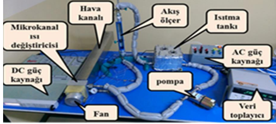
Őekil 2.4 Newton kuralına uyan DI su ile karbon tabanlı nanoakıřkanların performans testlerinin yapıldıđı deney dzeneđi.
