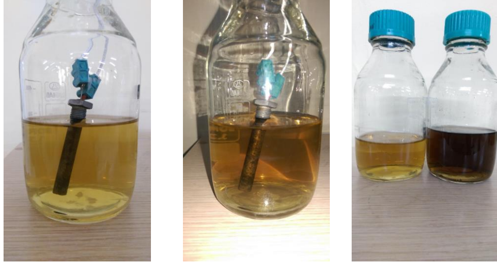
Şekil 3.9 Kütlece %0.01 bölüntü oranında hazırlanan Grafen oksit/DI su nanoakışkanına 200 W'lık ısı yükü verildikten sonra aldığı durum.
