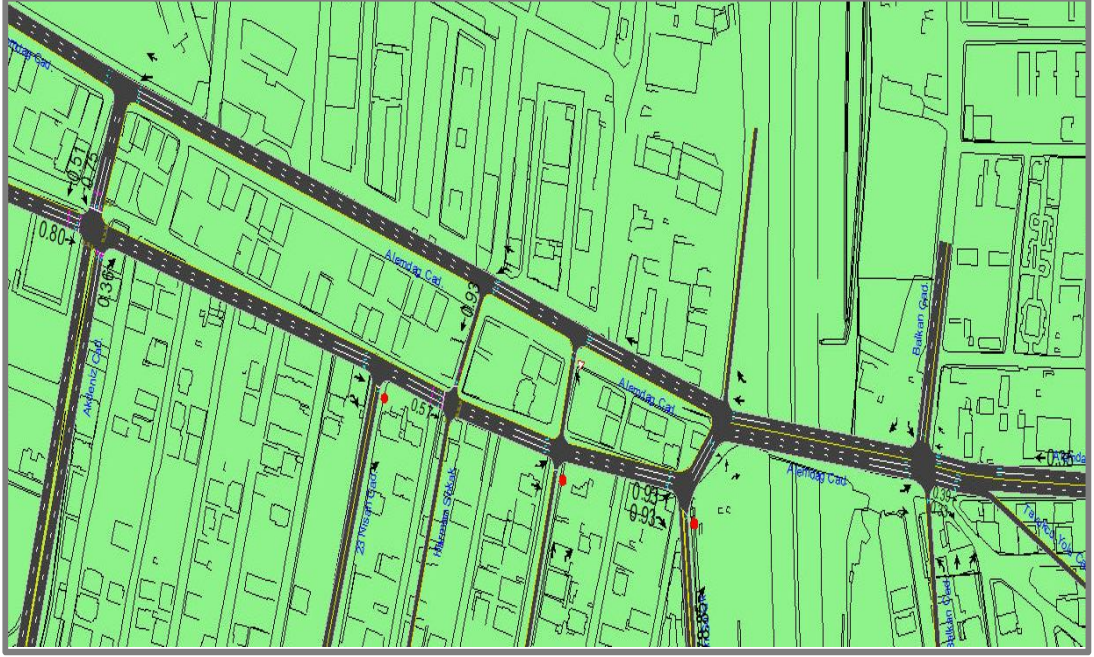
Şekil 4. 52: Yaklaşım kolları üzerinde hacim/kapasite (v/c) oranları (Akşam Zirve)
