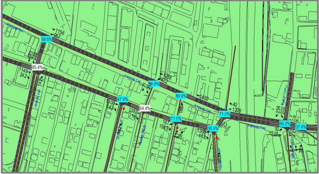
Şekil 4. 50: Yaklaşım kolları üzerinde trafik hacimleri ve kavşak kapasite kullanım yüzdeleri (Akşam Zirve)
