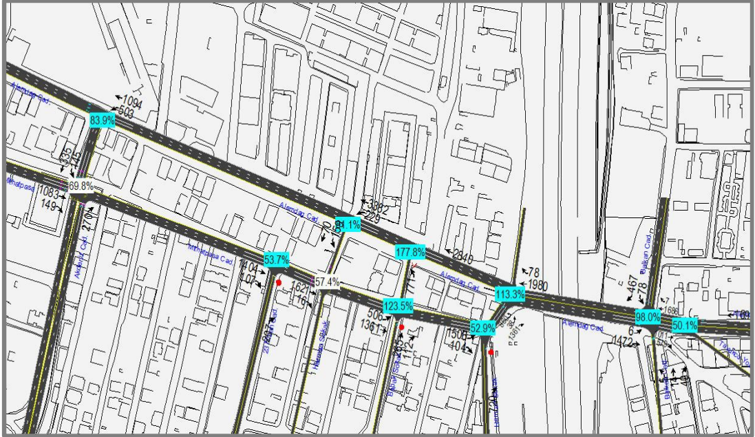
Şekil 4. 49: Yaklaşım kolları üzerinde trafik hacimleri ve kavşak kapasite kullanım yüzdeleri (Sabah Zirve)
