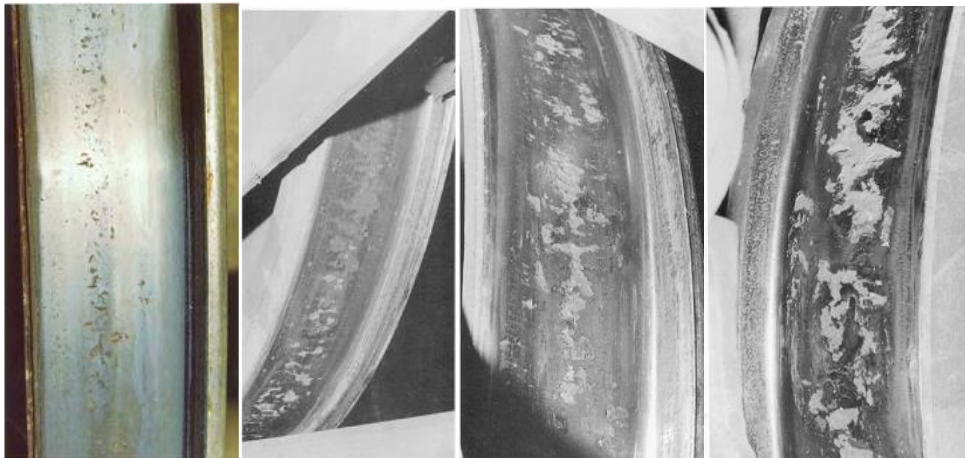
Şekil 6.10 1. , 2. , 3. ve 4. Dereceden Oyuklanma Olan Tekerlekler [39]
