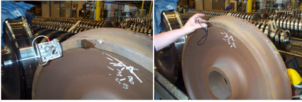
Şekil 6.2 EMAT ve PET Yöntemi ile Tekerlek Kalıntı Gerilim Ölçümü [33]
