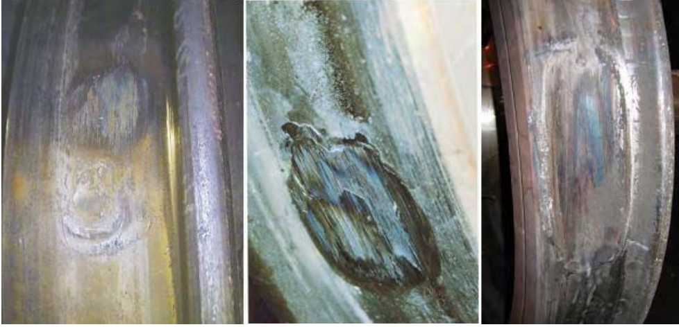
Şekil 6.12 3. , 4. ve 5. Dereceden Apleti Olan Tekerlekler [39]
