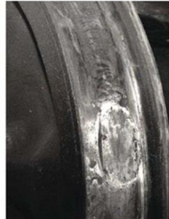
Şekil 5.8 Tekerleklerde Apleti Durumu [22]
