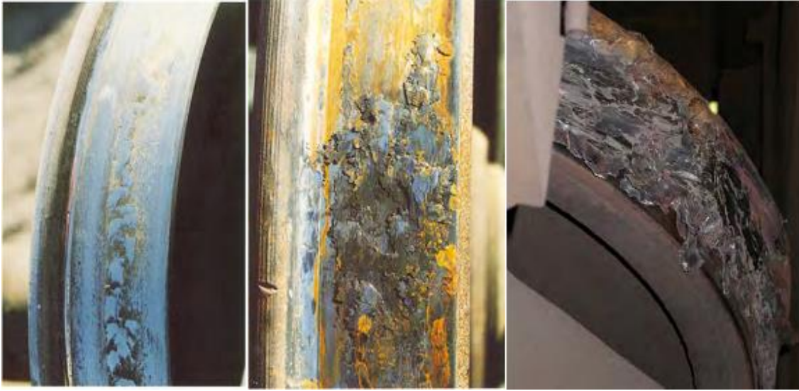
Şekil 6.11 3., 4. ve 5. Dereceden Yığılma Olan Tekerlekler [39]
