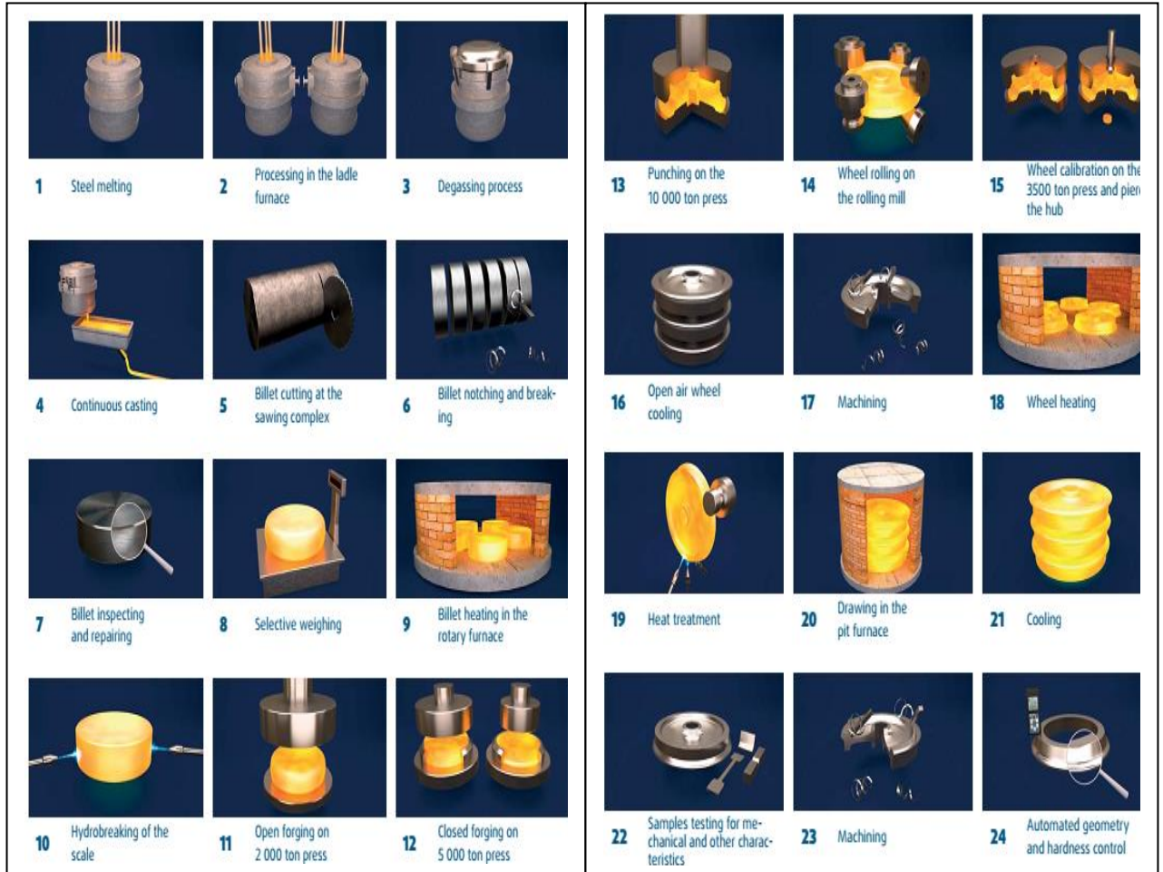
Şekil 3.2 Monoblok bir tekerin üretim aşamaları [20]
