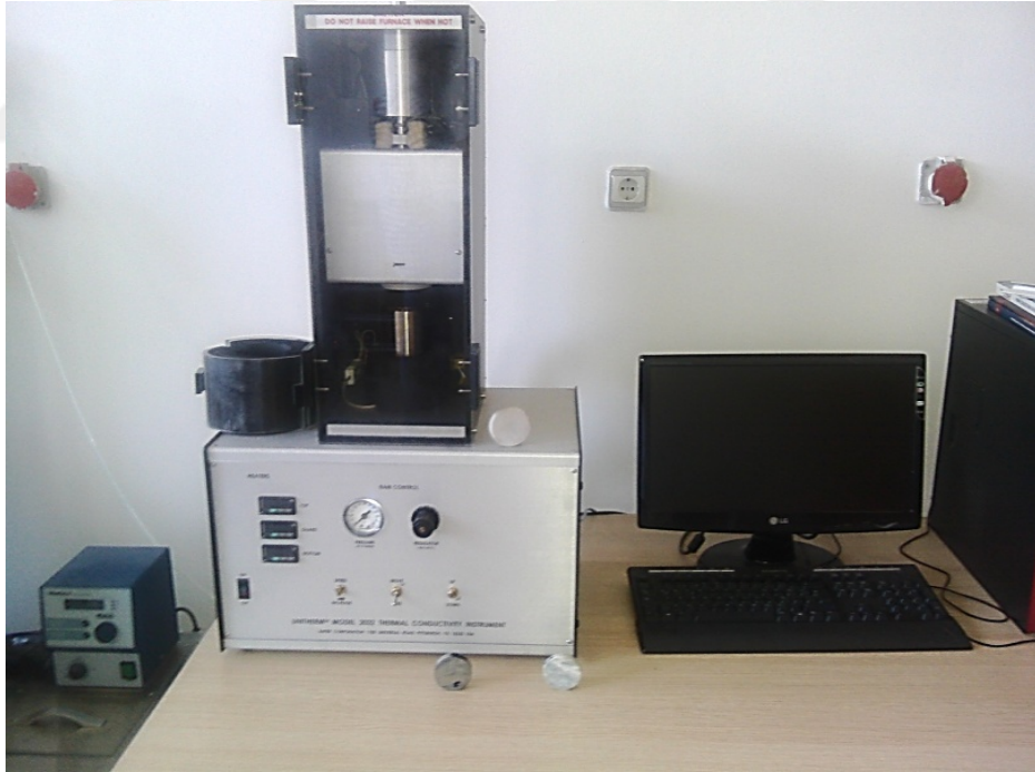
Şekil 3.56 Anter Unitherm 2022 model muhafazalı ısı akış ölçer cihazı.
