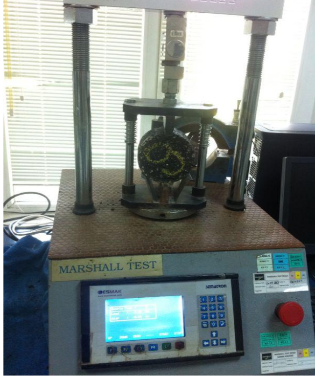
Şekil 5.10 Dolaylı çekme mukavemeti deneyinin uygulandığı Marshall numunesi
