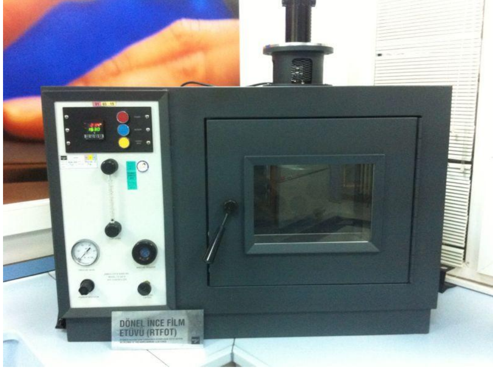
Şekil 3.18 Dönel ince film halinde ısıtma deney aleti
