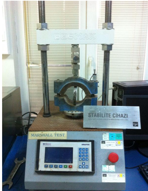
Şekil 5.3 Marshall yükleme cihazı
