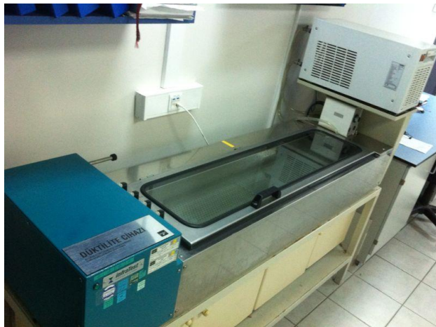
Resim 3.13 Düktilite deney düzeneği
