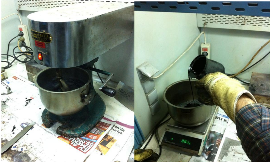
Şekil 5.6 Değişik bitüm yüzdelere göre karışımların hazırlanması
