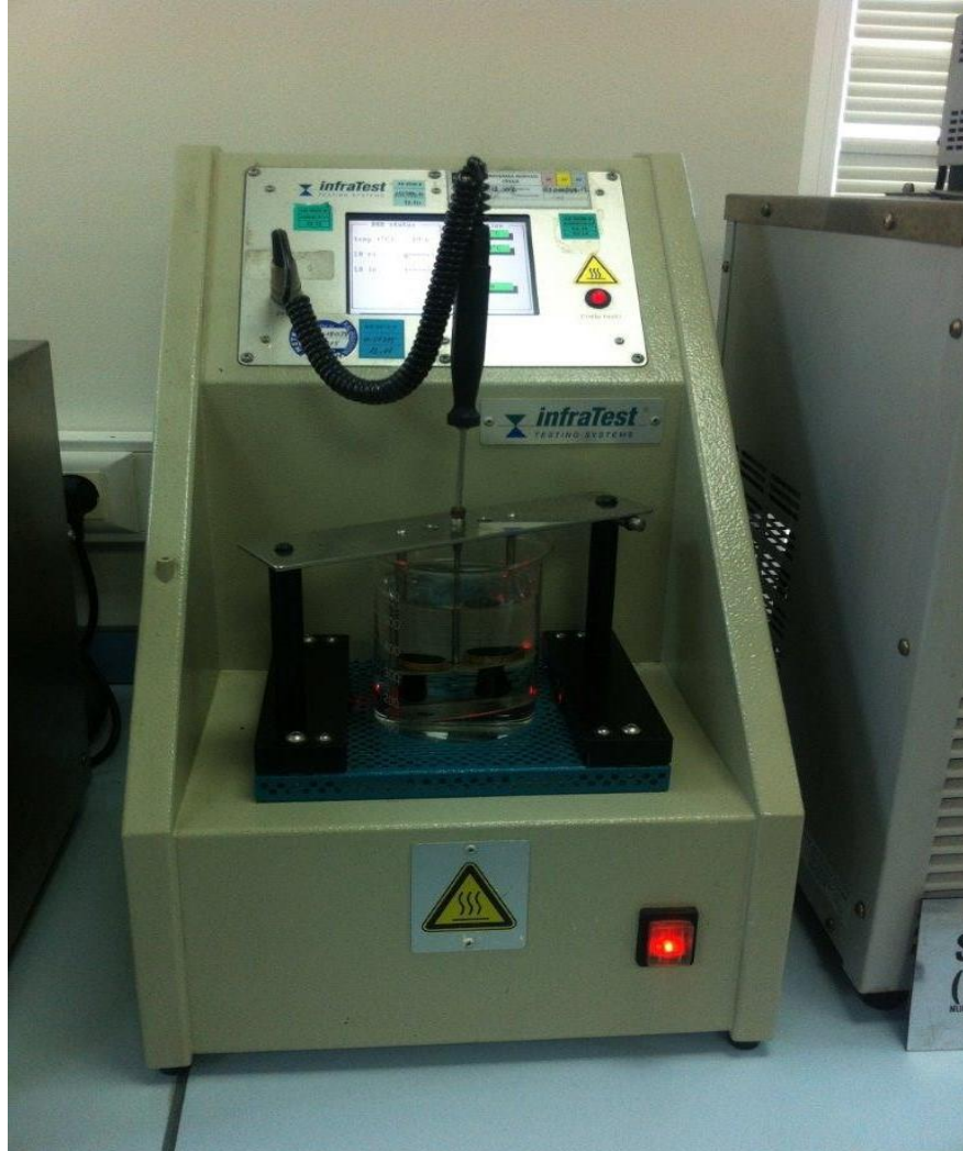
Şekil 3.15 Yumuşama noktası için halka tutucu deney düzeneği
