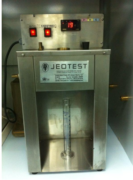
Şekil 3.16 Viskozite deney düzeneği
