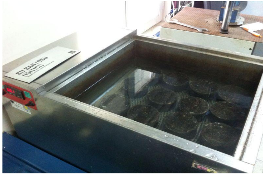
Şekil 5.4 Marshall numunelerinin su banyosunda bekletilmesi
