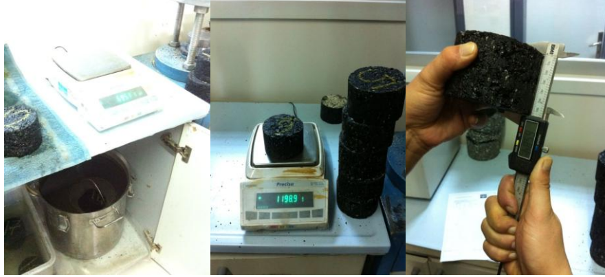
Şekil 5.7 Briketlerin yükseklik ölçümü, havada ve suda tartımları
