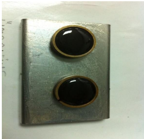
Şekil 3.14 Halka içinde hazırlanmış olan deney numuneleri
