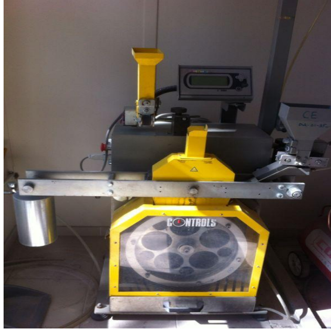
Şekil 3.5 Cilalanma deney cihazı
