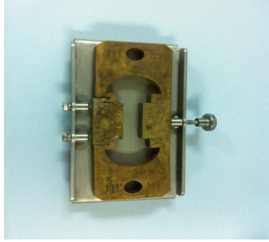
Şekil 3.12 Düktilite deney düzeneğinde kullanılan pirinç kalıp
