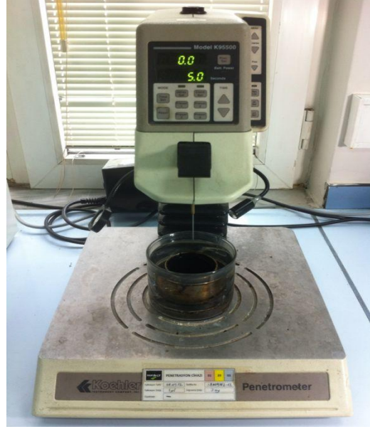
Şekil 3.11 Penetrasyon deney düzeneği
