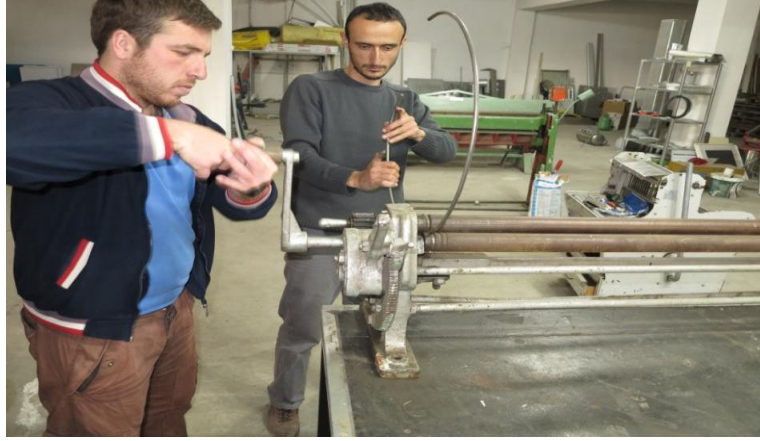
Şekil 3.4. Sepet demirlerinin kıvrılması
