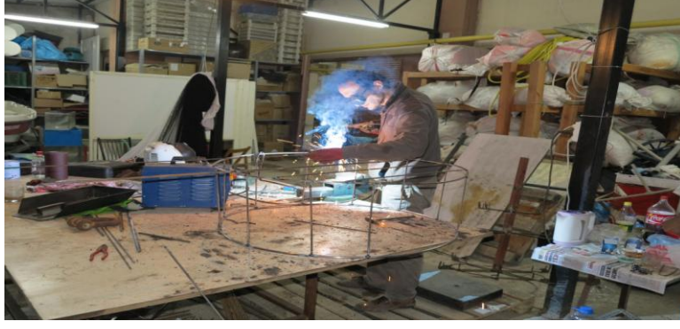
Şekil 3.6. Sepet demirlerinin kaynak işlemi
