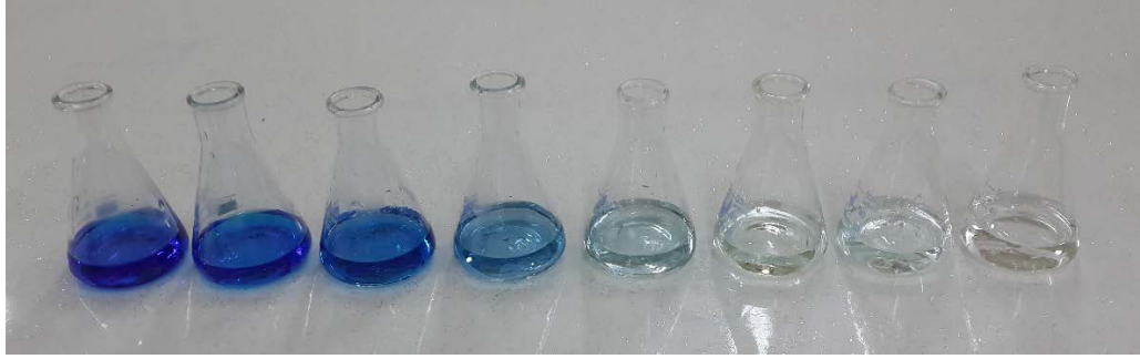
Şekil 21 25 g/L MM çözeltisinin 1 g/L TiO 2 ile pH 2,5'ta renk giderimi (Sol baştan; başlangıç, 0.dk ve 30 dk arayla alınan numuneler)
