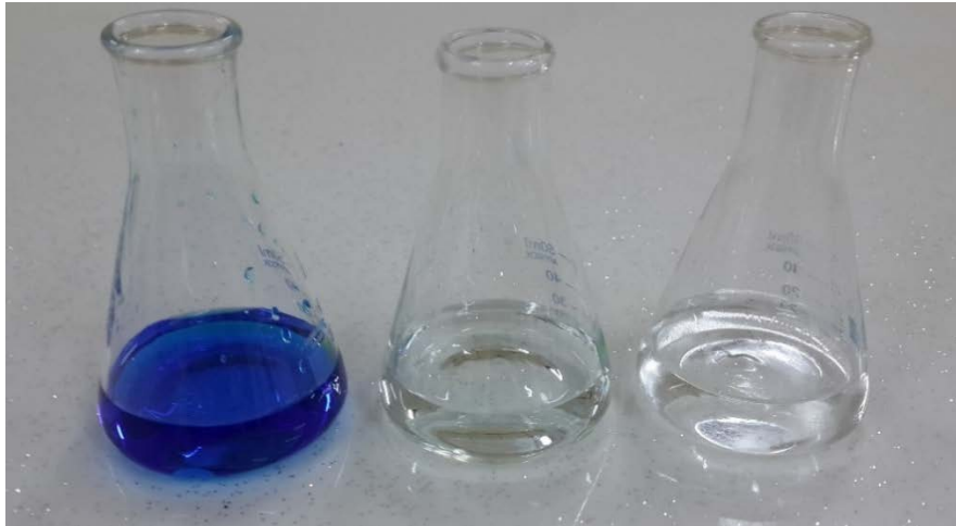
Şekil 47 25 mg/L MM başlangıç kons. (soldaki), 1 g/L ZnO ile pH 9'da arıtılmış su (ortadaki) ve 1 g/L TiO 2 ile pH 2,5'te arıtılmış su (sağdaki).
