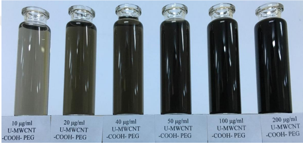
Şekil 2.9 Yukarıdan aşağıya sırası ile U-MWCNTs-COOH ve U-MWCNTs-COOH/PEG nanoparçacıkların DI su taban akışkanına dağıtılması ile 10-200 µg/ml derişim aralığında üretilen nanoakışkan görüntüleri.
