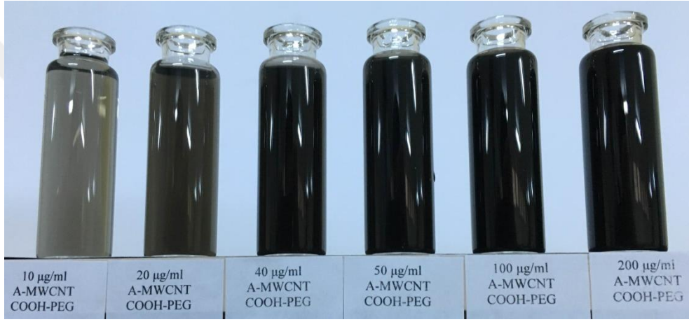
Şekil 2.10 Yukarıdan aşağıya sırası ile A-MWCNTs-COOH ve A-MWCNTs COOH/PEG nanoparçacıkların DI su taban akışkanına dağıtılması ile 10-200 µg/ml derişim aralığında üretilen nanoakışkan görüntüleri.
