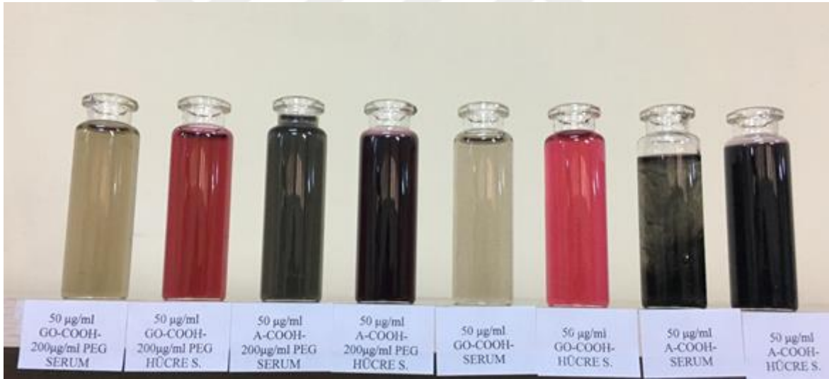
Şekil 3.14 PEG ile fonksiyonlaştırılmış ve fonksiyonlaştırılmamış GO ve A-MWCNTs nanoparçacıkların serum ve hücre sıvısı içerisine dağıtılması ile üretilen taşıyıcı sistemlerin hazırlandıktan bir gün sonraki görüntüleri.
