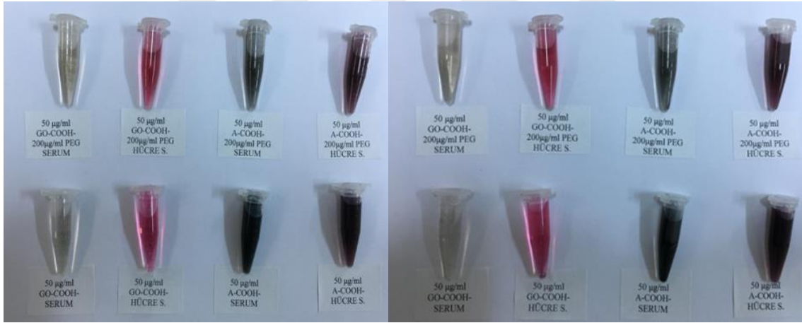
Şekil 3.16 PEG ile fonksiyonlaştırılmış ve fonksiyonlaştırılmamış GO ve A-MWCNTs nanoparçacıkların serum ve hücre sıvısı içerisine dağıtılması ile üretilen taşıyıcı sistemlerinin a) santrifüj edilmeden ve b) 1000 rpm dönüş hızında 5 dakika süre ile santrifüj edildikten sonraki durumları
