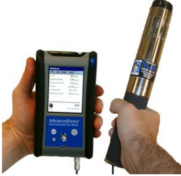
Şekil 3.5. İç ortam hava kalitesi ölçüm cihazı – 1
