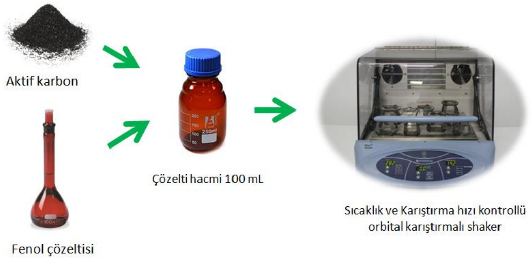
Şekil 2.4 Fenolün aktif karbona adsorpsiyon süreci.
