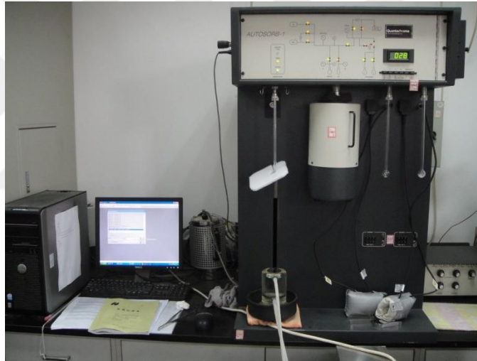
Şekil 2.5 Yüzey alanı, gözenek hacmi ve gözenek boyut dağılımı cihazı.
